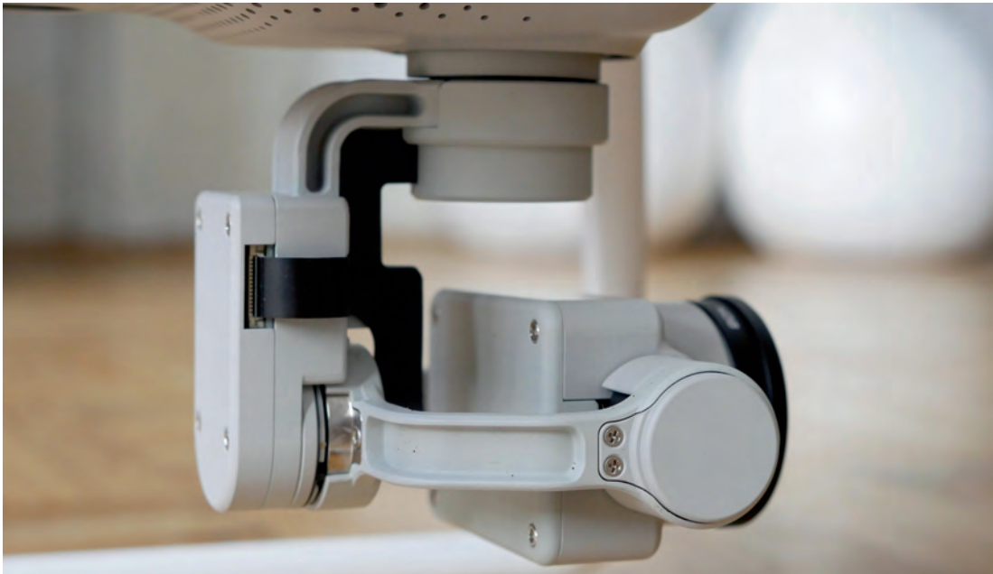
Detailopname van een gimbal. Een delicaat stukje mechatronica! Bron: DJI.
