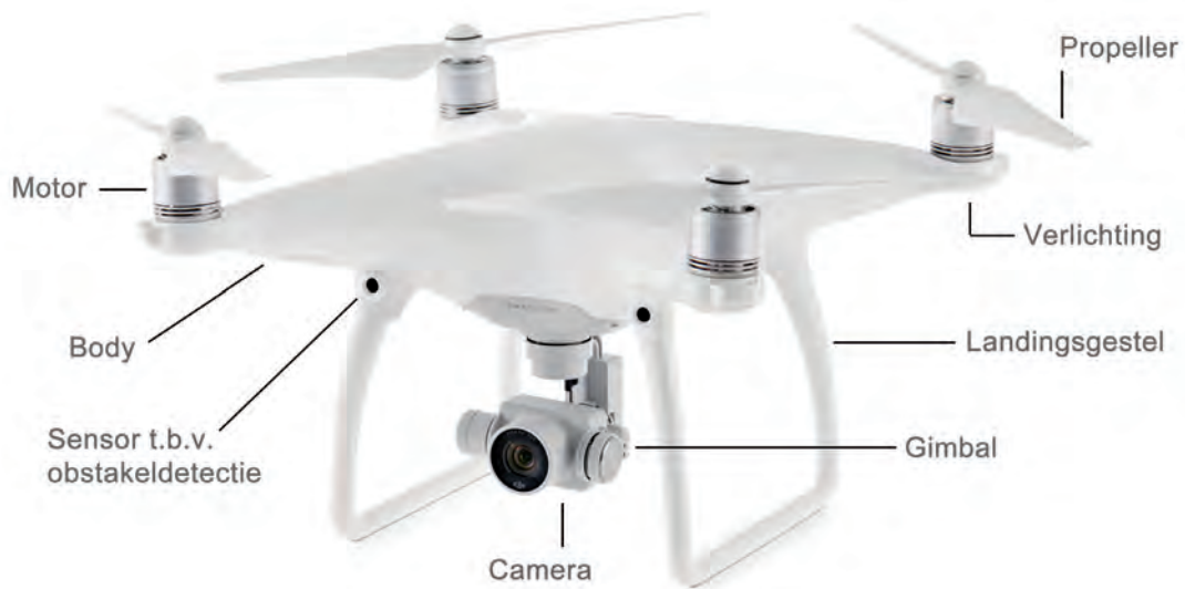
De belangrijkste zichtbare onderdelen van een ready to fly cameradrone. Bron: DJI.
