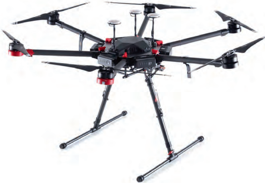
De DJI Matrice 600 beschikt over een hoog landingsgestel, om zodoende voldoende ruimte te maken voor gimbal, camera's en andere payloads. Bron: DJI.
