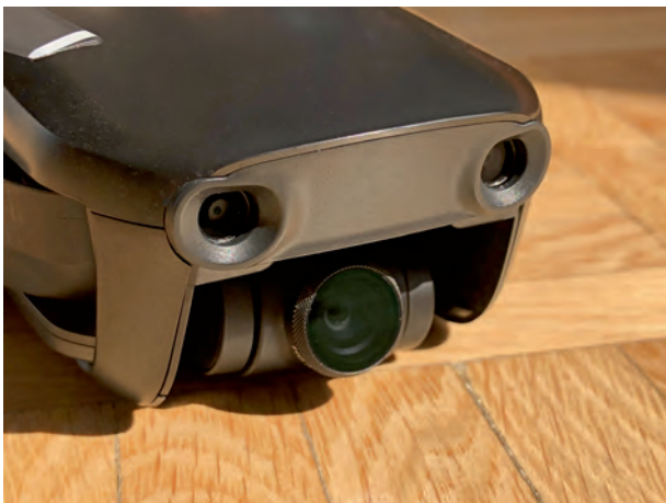
Deze twee kleine camera's aan de voorzijde van een DJI Mavic Air zorgen voor obstakeldetectie in voorwaartse vliegrichting.
