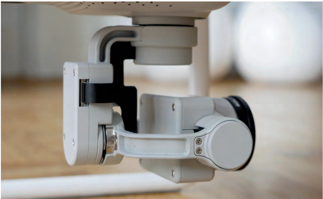
Detailopname van een gimbal. Een delicaat stukje mechatronica!
