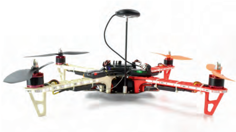
Op deze zelfbouwdrone is de GPS-ontvanger duidelijk zichtbaar. Bron: thehobbyworx.com.
