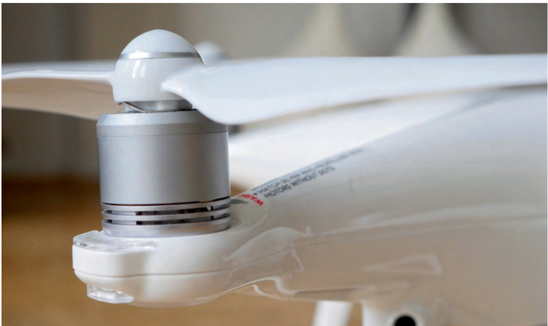
Een close-up van een van de motoren van een DJI Phantom 4. Rechtsonder is ook een van de camera's ten behoeve van de obstakeldetectie zichtbaar.
