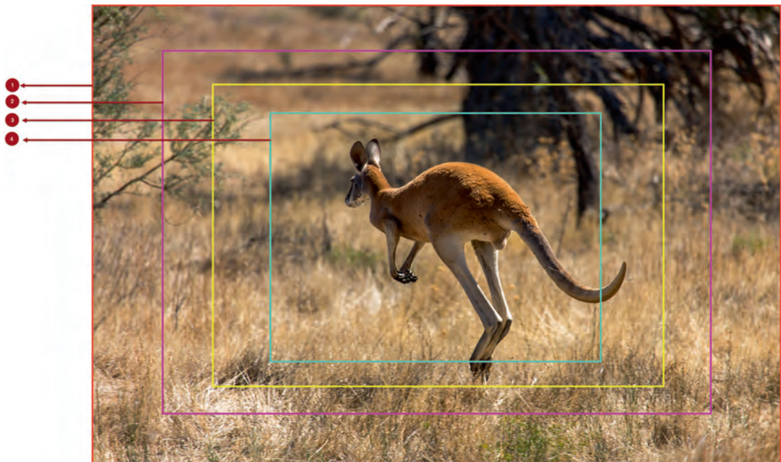
1 - Full frame gebruikt het volledige beeld. 2 - APS-H gebruikt een deel van het beeld. 3 - APS-C en 4 - Four Thirds gebruiken een nog kleiner deel van het beeld.
