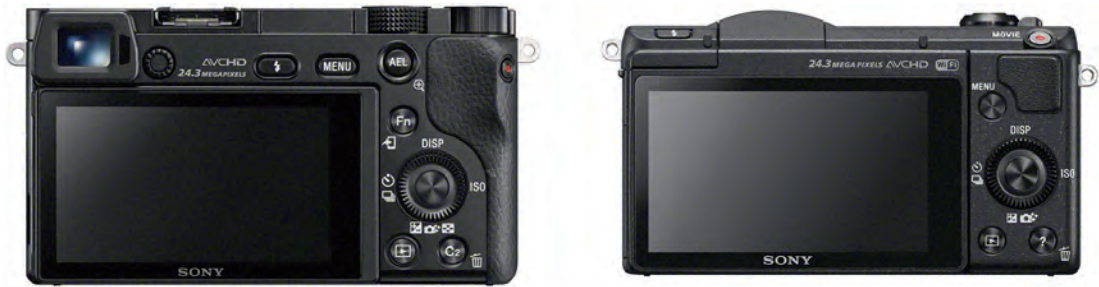
Links een systeemcamera met elektronische zoeker en een lcd-scherm op de achterzijde, rechts een systeemcamera zonder zoeker maar alleen met een lcd-scherm.
