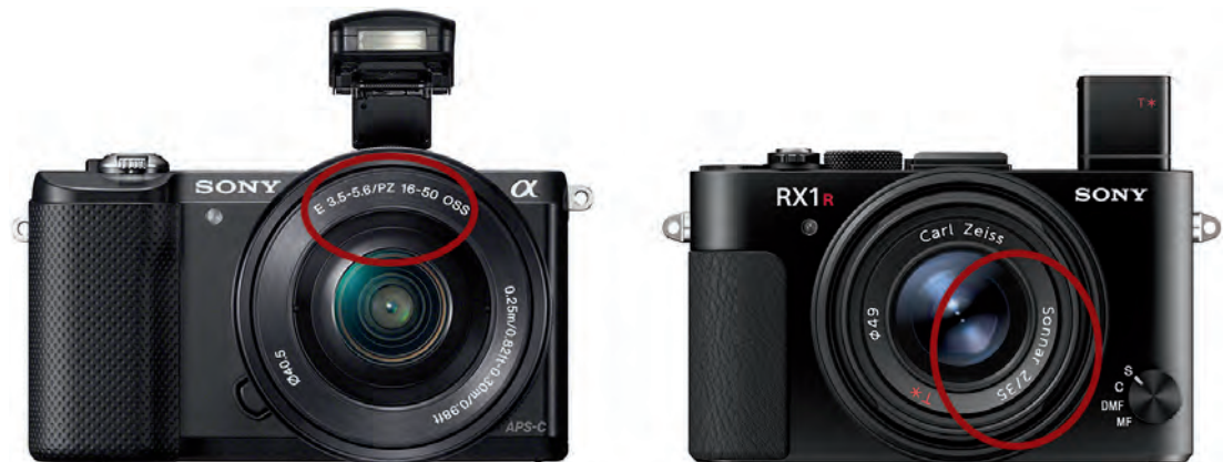
Rechts een camera met een objectief met een vaste 35mm-brandpuntsafstand en grootste diafragmaopening van f/2 (2/35), links een 16-50mm-zoomobjectief, de grootste diafragma waarde op 16 mm is f/3.5 en op 50 mm is dit f/5,6.
