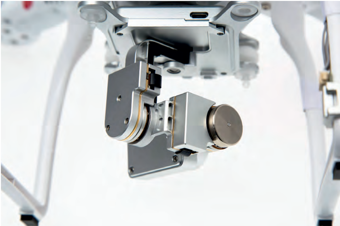
Detailopname van een gimbal. Een delicaat stukje mechatronica! Bron: DJI.
