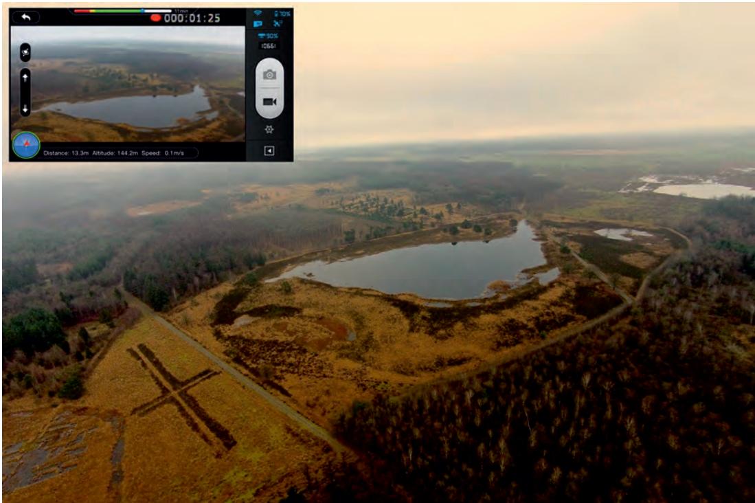
Op afstand meekijken met de camera van uw drone: het kan dankzij first person view. Linksboven een screenshot van het display op het moment van de opname, samen met de uiteindelijke foto. Bron: Roel van der Baan.
