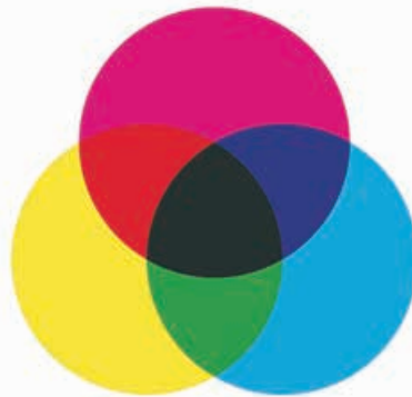
Subtractieve kleurmenging ontstaat door selectieve absorptie van het witte licht door een of meer verschillende kleurstoffen. Als u cyaan, magenta en geel over elkaar heen drukt, dan resulteert dat in zwart, de kleur die al het licht absorbeert.
