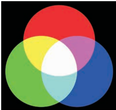
Additieve kleurmenging ontstaat door menging van licht van verschillende kleuren. Wanneer de drie lichtbronnen met de primaire kleuren rood, groen en blauw samenvallen, ontstaat wit licht.
