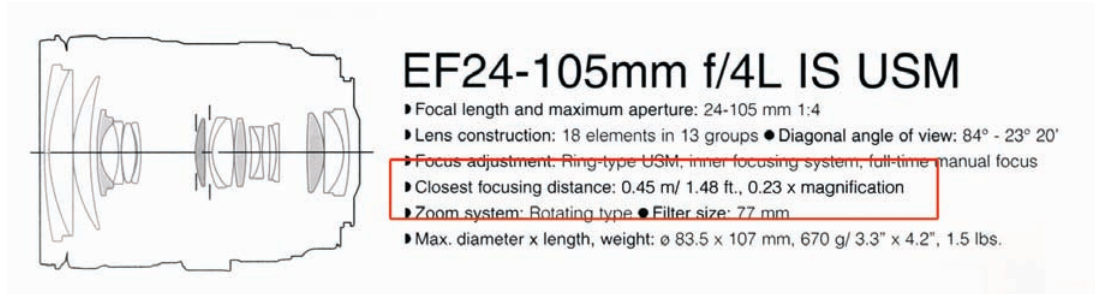
Specificaties van een lens met onder andere de kortste scherpstelafstand en de afbeeldingsmaatstaf (vergrotingsfactor).
